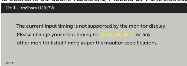
Ovo znači da monitor ne može da se sinhronizuje sa signalom koji prima od kompjutera. Pogledajte [Monitor Specifications \(Specifikacije monitora\)](#) za opsege horizontalne i vertikalne frekvencije koje ovaj monitor konstantuje. Preporučeni režim je 2560 x 1080. Možete da vidite sledeću poruku pre nego što se DDC/CI funkcija deaktivira:
